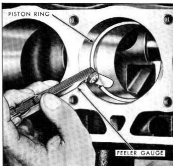
Fig. 6A-43—Measuring Piston Ring End Gap—(60C-5643)
